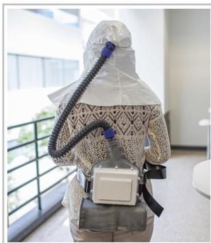
Ford hat an der Entwicklung eines Luftreinigungs-Atemschutzgerätes mitgearbeitet, dass für die Behandlung von Corona-Patienten eine Zufuhr von 99,97 Prozent gefilterter Luft für bis zu acht Stunden bietet.
