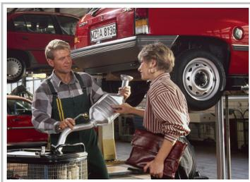
Einbau Katalysator in Opel-Werkstatt.
