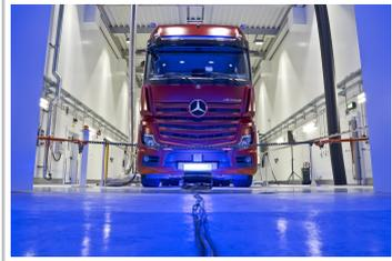
Lkw-Rollenprüfstand im Mercedes-Benz-Werk Wörth.
