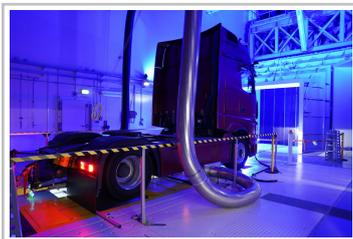
Lkw-Rollenprüfstand im Mercedes-Benz-Werk Wörth.
