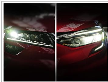
Links ein Scheinwerfer mit „Linsenprojektionssystem“. Der Rechte, mit Reflektortechnik blendet deutlich weniger.
