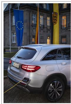
Der Dienstwagen von Ministerpräsident Winfried Kretschmann: Der Mercedes-Benz GLC F-Cell verfügt weltweit einmalig sowohl über Brennstoffzellen- als auch über Batterieantrieb mit Plug-in-Technologie.
