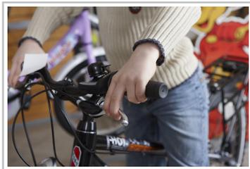
Auch Kinderräder wollen gut eingestellt sein. Von Bedeutung ist etwa die richtige Stellung der Bremshebel, die je nach Sattel- und Lenkerhöhe variiert. Nur so sind ein schneller Griff zum Hebel und eine ergonomische Handhaltung garantiert.
