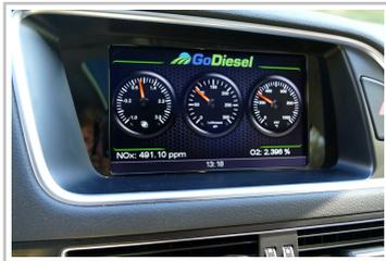
Go Diesel will mit Wasserenspritzung die Verbrennungstemperaturen im Dieselmotor und damit die NOx-Emissionen senken.
