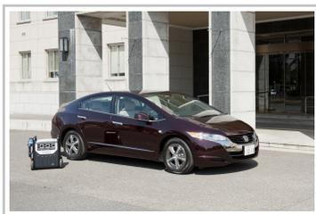
Der Honda FCX Clarity wird bei Bedarf zu einem 9 kW / 12 PS starken mobilen Stromgenerator.
