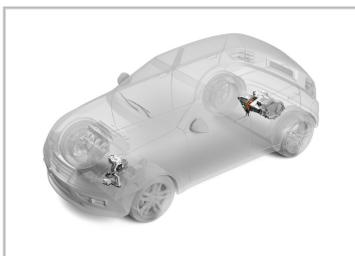
Aufbau des ZF-Systems „eAMT“ oder „electrified Automated Manual Transmission“.
