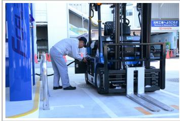
Toyota-Gabelstapler mit Brennstoffzellenantrieb.
