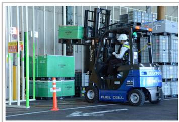
Toyota-Gabelstapler mit Brennstoffzellenantrieb im Werk Motomachi.
