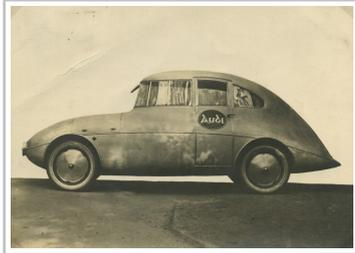
Der Audi Typ K Stromlinie wies schon 1923 eine komplette Aluminiumkarosserie auf.
