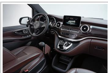
Für Menschen mit Handicap: Mercedes-Benz mit Multifunktionsdrehknopf „MFD Touch“ und Handbediengerät „Easy Speed“.
