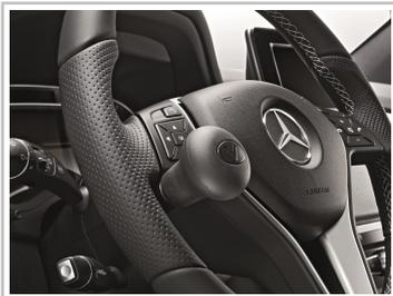
Für Menschen mit Handicap: Mercedes-Benz mit Lenkraddrehknäuf.
