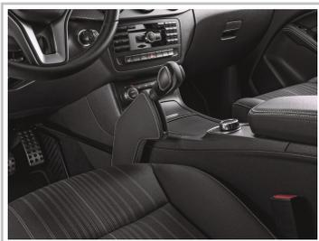
Für Menschen mit Handicap: Mercedes-Benz mit Handbediengerät „Easy Speed“.
