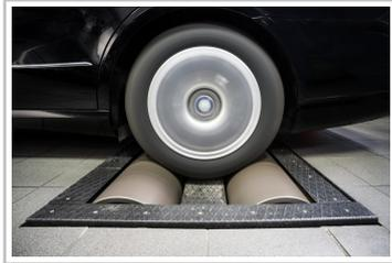
Test auf dem Rollenprüfstand.
