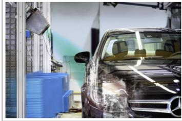
Mercedes-Benz testet Ultrakurzzeit-Röntgentechnologie beim Crashtest. Damit lässt sich das Verformungsverhalten sicherheitsrelevanter Bauteile auch in ihrem Inneren untersuchen.
