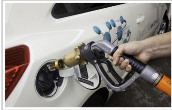
Ab sofort ergänzt eine LPG-Variante die Corsa-Familie. Der im Drei- und Fünftürer verfügbare 1,2-Liter- Motor leistet im Autogasbetrieb 61kW / 83 PS.
