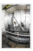
Ein Mitarbeiter des Mercedes-Benz-Werks Gaggenau lackiert eine Achse mit dem neuen Trockenabscheideverfahren. Unten sind die Abscheidungslamellen zu sehen.
