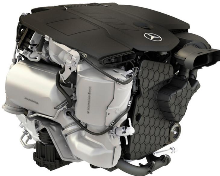
Vier-Zylinder-Diesel OM 654: Die Abgas-Nachbehandlung sitzt komplett am Motor.
