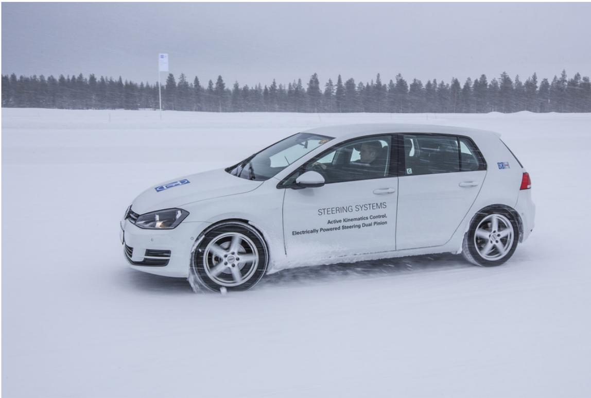
ZF-Prototyp mit zusätzlicher Hinterachslenkung.
