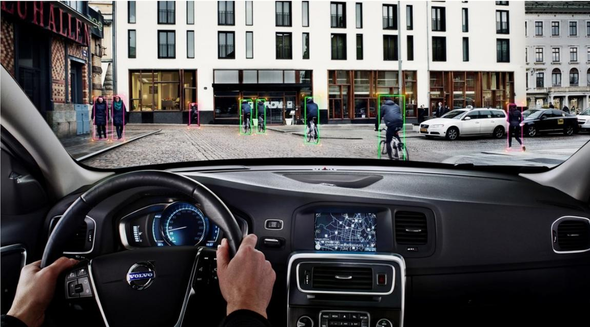
Notbremsassistent mit Fußgänger- und Radfahrerererkennung.
