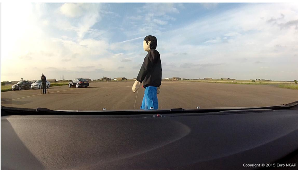
Euro NCAP testet die Fußgängererkennung moderner automatischer Notbremsassistenten.
