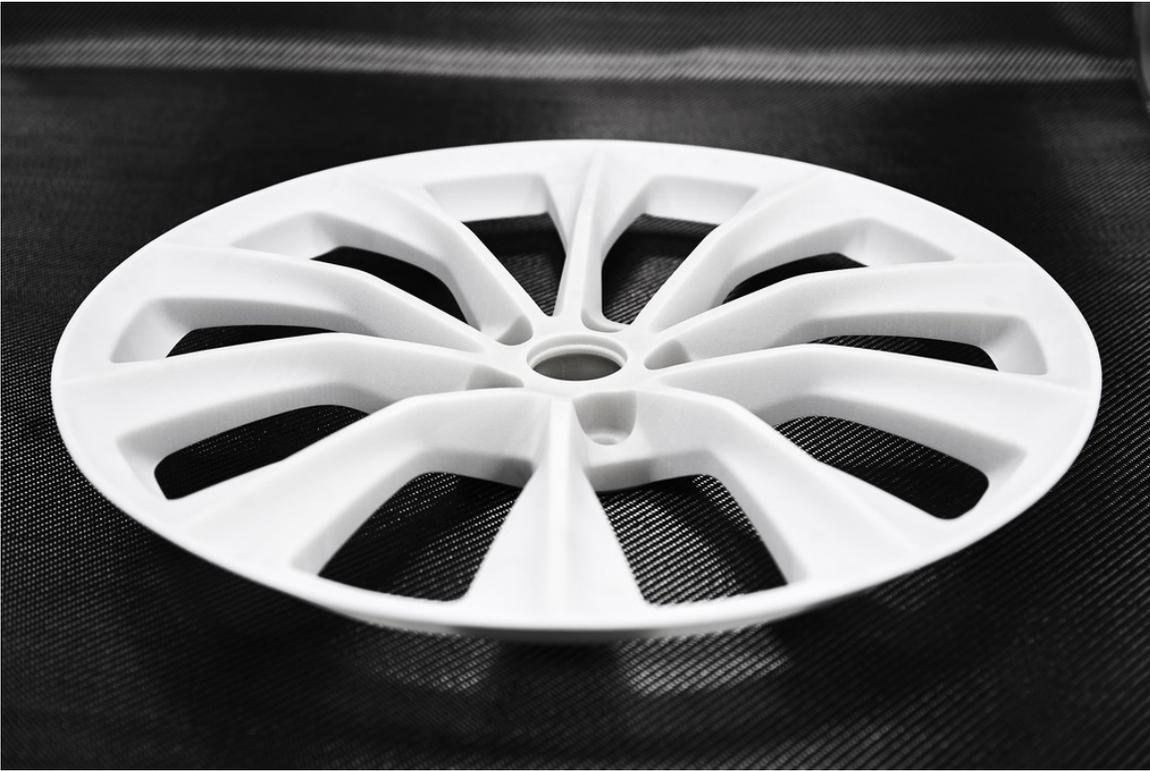
Ford nutzt 3-D-Drucke bei der Vorentwicklung neuer Fahrzeugteile.
