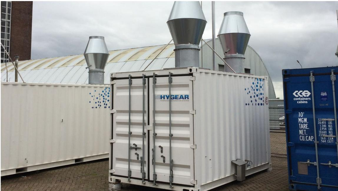
Die kompakte Anlage wandelt Diesel und Biodiesel in Wasserstoff um.
