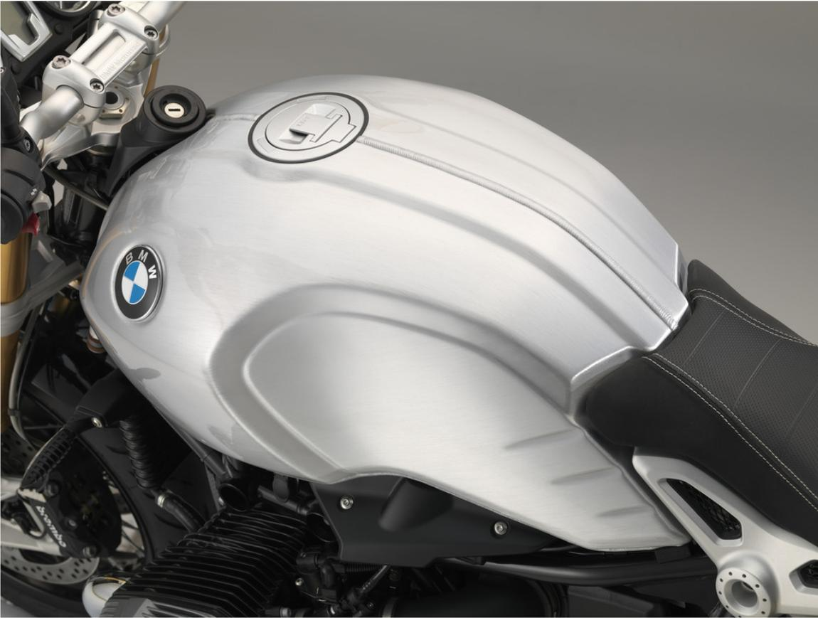
BMW R Nine T mit sichtbarer Schweißnaht am handgebürsteten Aluminiumtank.
