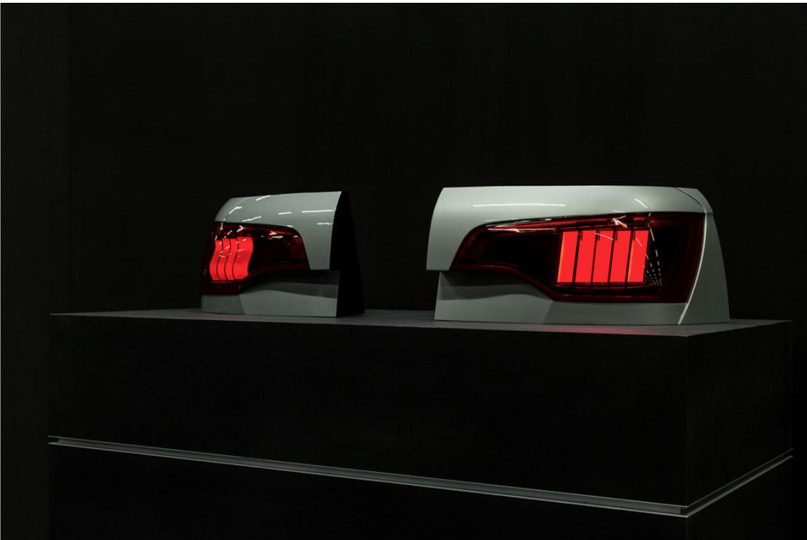
OLED in einem Heckleuchten-Modell bei Audi.
