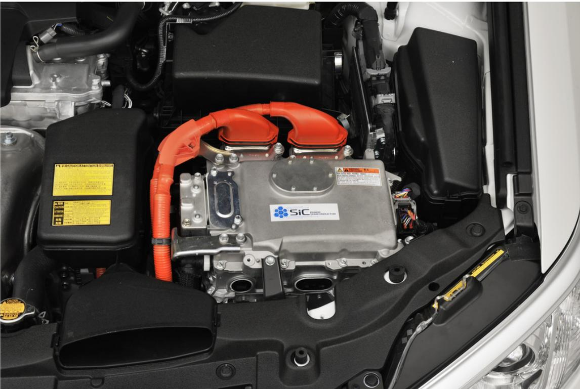
Testwagen mit Siliziumkarbid-Halbleitern.
