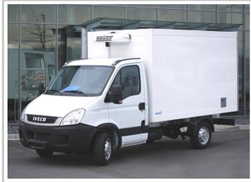
Den Iveco Daily gibt es jetzt in verschiedenen Versionen mit zulässigen Gesamtgewichten von 3,5 t bis 7,0 t (ab 3. Quartal 2010) mit Kühlaufbau von Kress. Im Bild der 3,5-Tonner mit 93 kW / 126 PS) starkem Dieselmotor.
