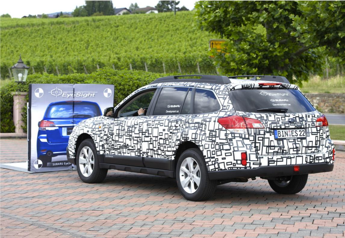
Eyesight nennt Subaru sein auf einer Stereokamera basierendes Fahrerassistenzsystem.
