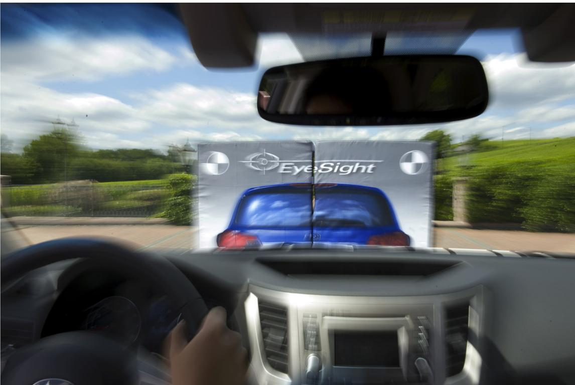
Eyesight nennt Subaru sein auf einer Stereokamera basierendes Fahrerassistenzsystem.
