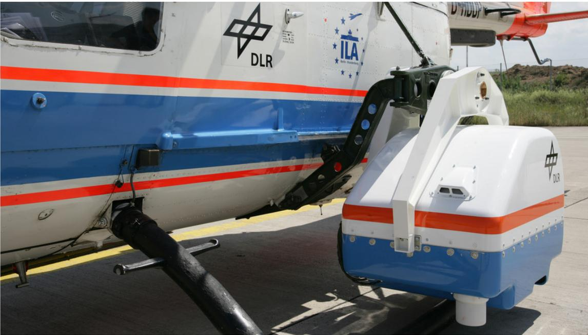
Kameragehäuse an der Außenseite des DLR-Hubschraubers.
