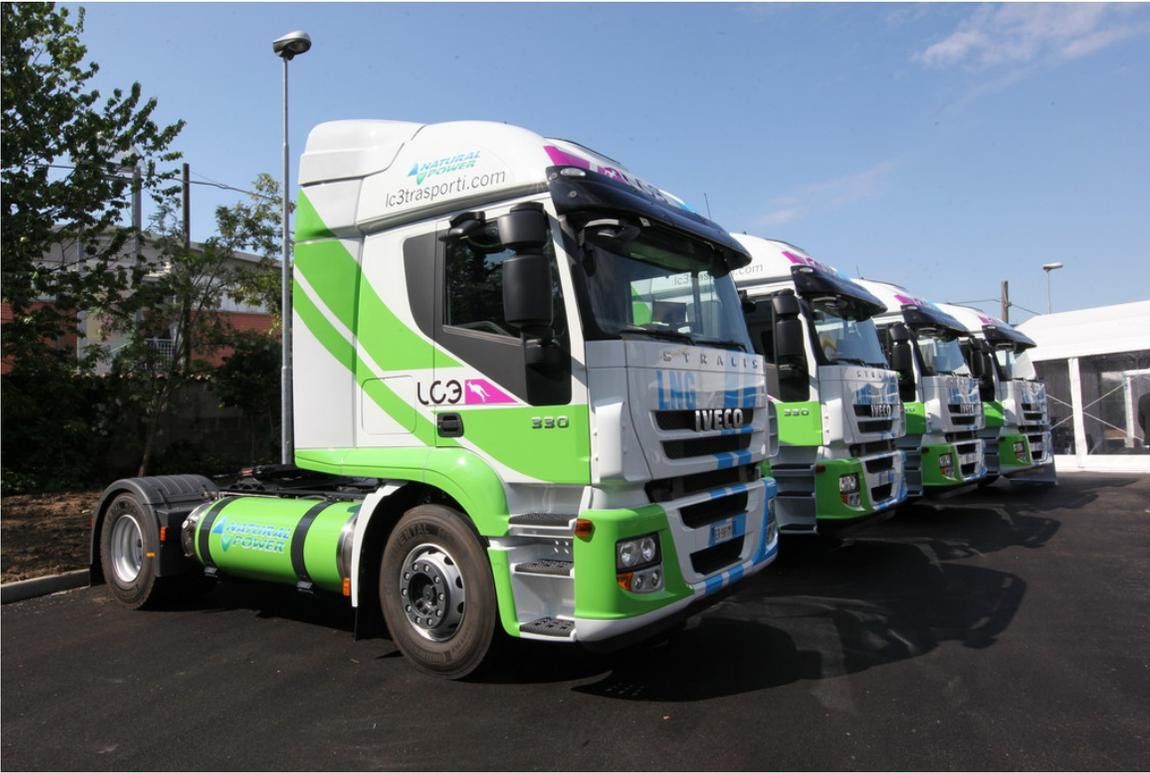
Vier der fünf Iveco Stralis AT440S33T/P LNG mit 330 PS für die Spedition LC3.
