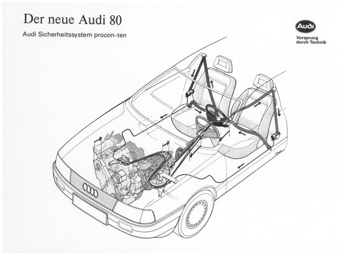
Sicherheitssystem Procon-ten von Audi (1986): Bei einem Frontalaufprall wurden durch Verschieben des Motors in Richtung Innenraum das Lenkrad zurückgezogen und die vorderen Gurte gestrafft.
