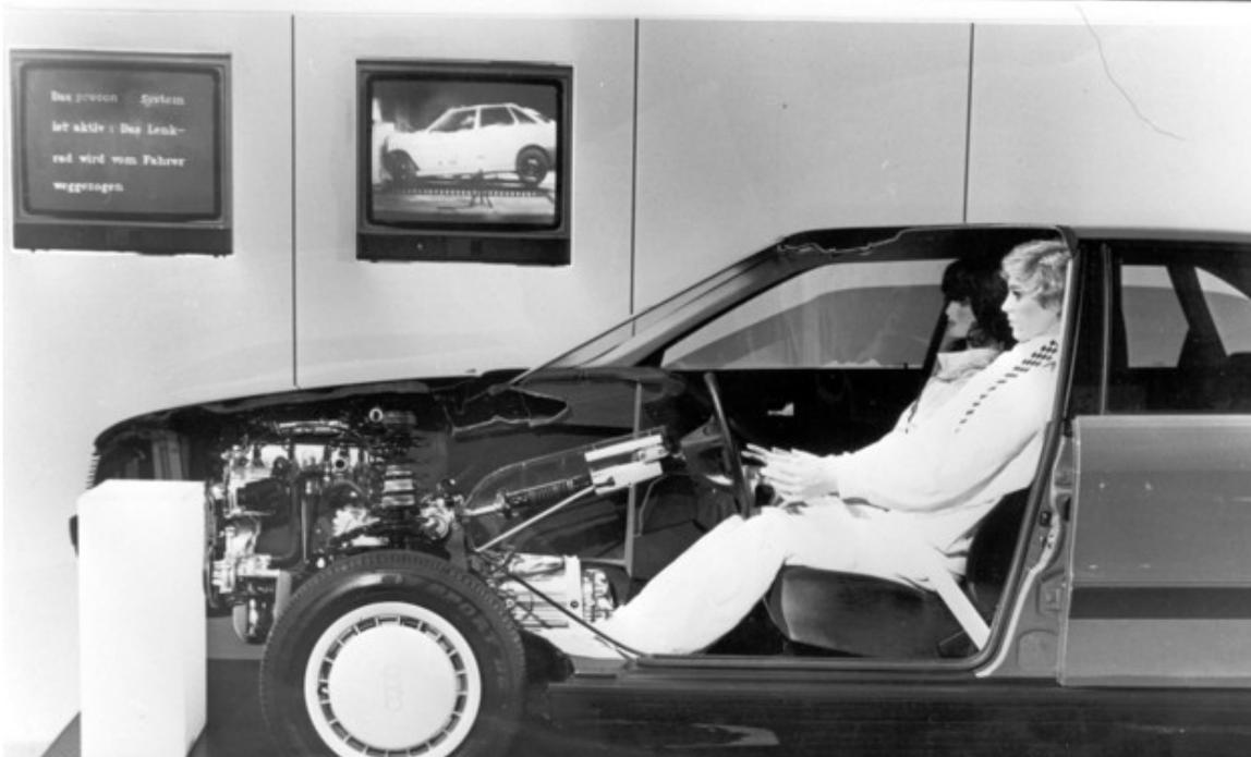
Sicherheitssystem Procon-ten von Audi (1986): Bei einem Frontalaufprall wurden durch Verschieben des Motors in Richtung Innenraum das Lenkrad zurückgezogen und die vorderen Gurte gestrafft.
