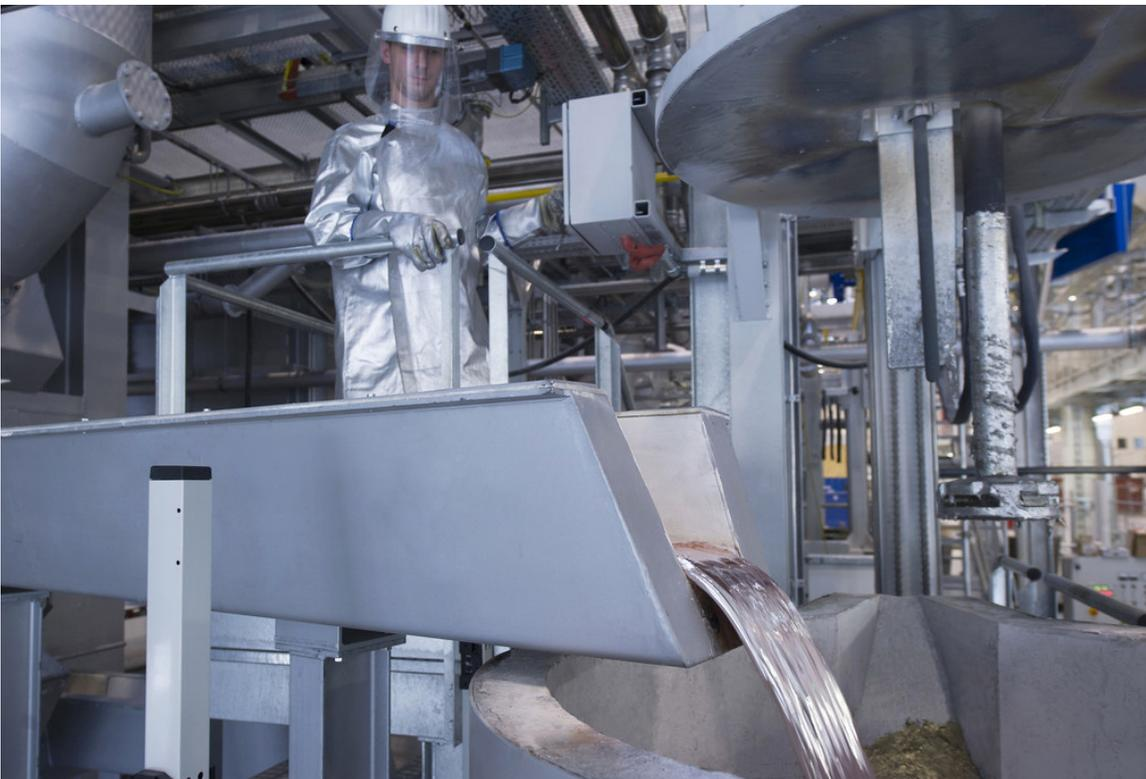
$\ddot{u}$ berf $\ddot{u}$ hrung der Schmelze in den Transport- bzw. Reinigungstiegel in der Audi-Fertigung
