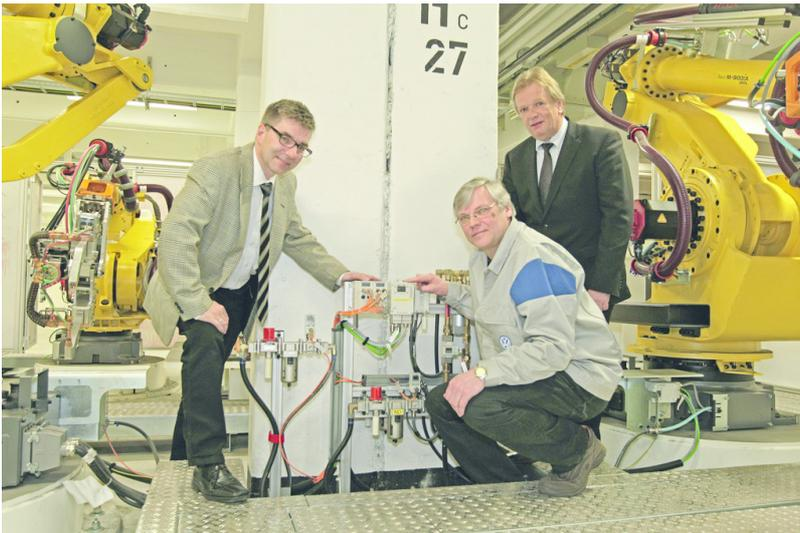
Volkswagen-Ideengeber-des-Monats Harry Ludwig (Mitte) zeigt Eckhard Ritz (rechts) und Maik Feuerhahn vom Ideenmanagement eine Roboterinstallationsplatte zur Steuerung von neuinstallierten Schweiß- und Greifrobotern.
