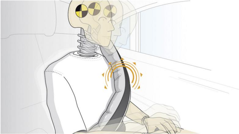
Auf dem Weg zur neuen S-Klasse: Mehr Sicherheit für die Hinterbänker durch einen Sicherheitsgurt, der sich beim Unfall zum Airbag aufbläst.
