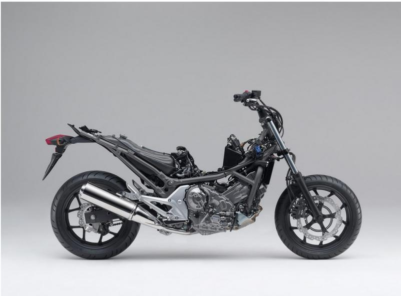
Unter dem Honda Integra stecken das gleiche Fahrwerk und der gleiche Motor wie bei der NC 700.
