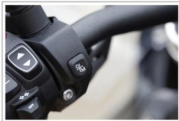
Der Automated Shift Assistant (ASA) von BMW ermöglicht beim Motorrad das Schalten ohne Kupplung.
