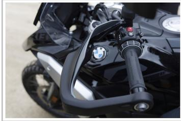
Der Automated Shift Assistant (ASA) von BMW ermöglicht beim Motorrad das Schalten ohne Kupplung: der linke Handhebel entfällt.
