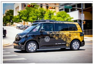
Selbstfahrender Prototyp eines VW ID Buzz.
