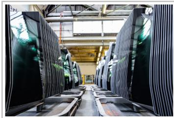
Audi verwendet für die Windschutzscheibe des Q4 e-Tron bis zu 30 Prozent Granulat aus nicht mehr reparierbaren Autoscheiben.
