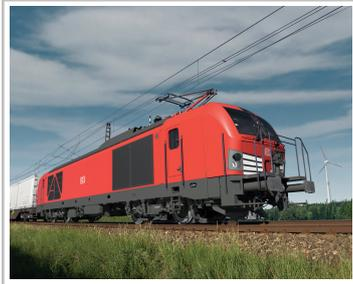
Zweikraftlok Typ Vectron Dual Mode.
