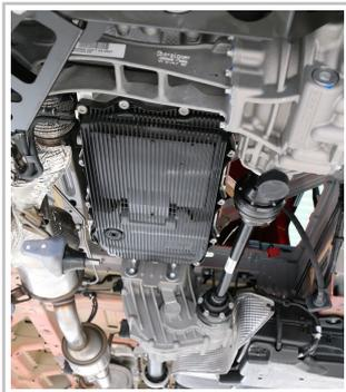
Die umgebaute Vorderachse (im Bild oben) sowie daran anschließend das Verteilergetriebe für den permanenten Allradantrieb in den schweren Versionen des MAN TGE.
