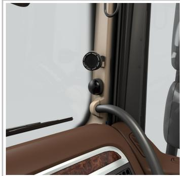
Der Abbiegeassistent im DAF warnt über ein LED-Display an der A-Säule auf der Beifahrerseite.
