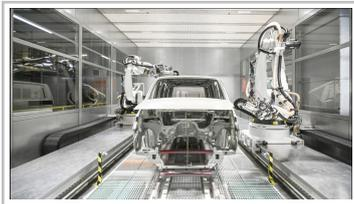
Decklackanlage im VW-Nutzfahrzeug-Werk Hannover:
