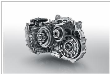
Automatikgetriebe aus dem Opel Crossland X.
