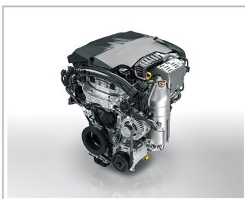
1,2-Liter-Turbo-Benzinmotor (EB2) mit 130 PS aus dem Opel Crossland X.
