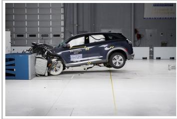
Brennstoffzellen-Fahrzeug Hyundai Nexo beim Crashtest.
