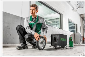
Lasergestütztes Scheinwerfereinstellprüfsystem (SEPS) der Dekra.
