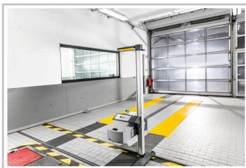
Lasergestütztes Scheinwerfereinstellprüfsystem (SEPS) der Dekra.
