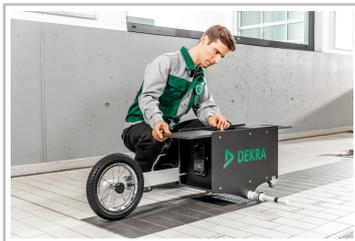
Lasergestütztes Scheinwerfereinstellprüfsystem (SEPS) der Dekra.
