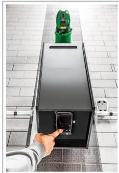
Lasergestütztes Scheinwerfereinstellprüfsystem (SEPS) der Dekra.
