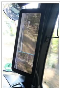
Mercedes-Benz Actros: Bildschirm der Mirror Cam auf der Beifahrerseite.
