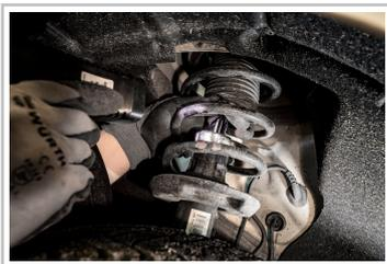
Stoßdämpfer sollten ab Laufleistungen von 80 000 Kilometern regelmäßig überprüft werden.
