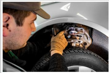
Ein Dekra-Prüfingenieur untersucht im Rahmen der Hauptuntersuchung einen Stoßdämpfer.
