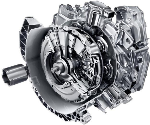
Twinamic-Doppelkupplungsgetriebe für Smart.
