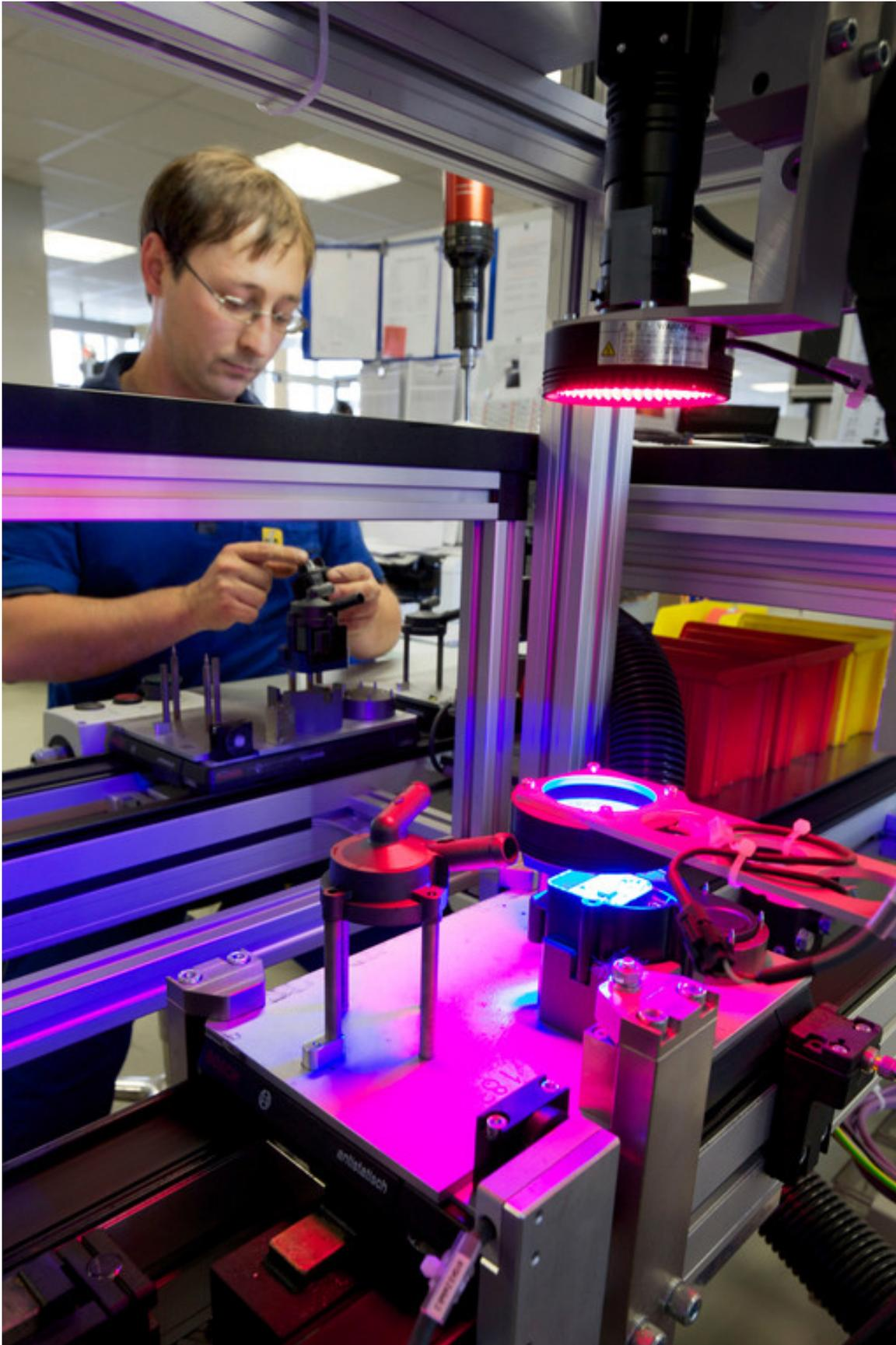
Optische Prüfung einer Wassermwälzpumpe bei der Pierburg Pump Technology GmbH
