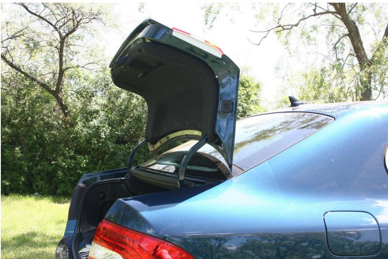
Twindoor-Heckklappe des Skoda Superb.
