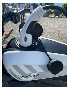
European Bike Week 2002: Eine Livewire One wird über die On-Board-Steckdose eines Ford E-Transit mit Strom versorgt.
